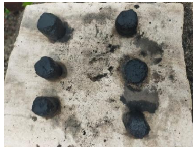
Gambar: 10. Proses Penjemuran Briket.
