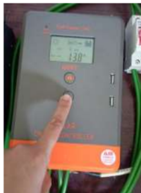
Gambar 5. Praktik penggunaan Solar Charge Controller
