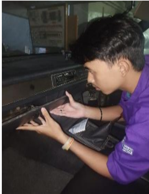
Gambar 2. Membuka Dashboard untuk Akses Pemeriksaan.
