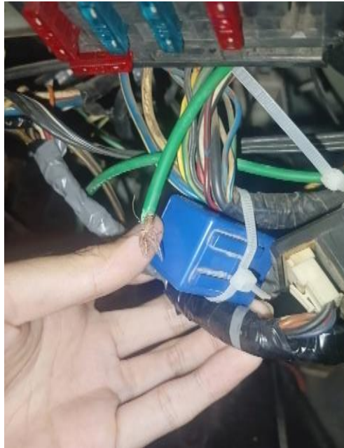
Gambar 4. Melepas Flasher Lama.
